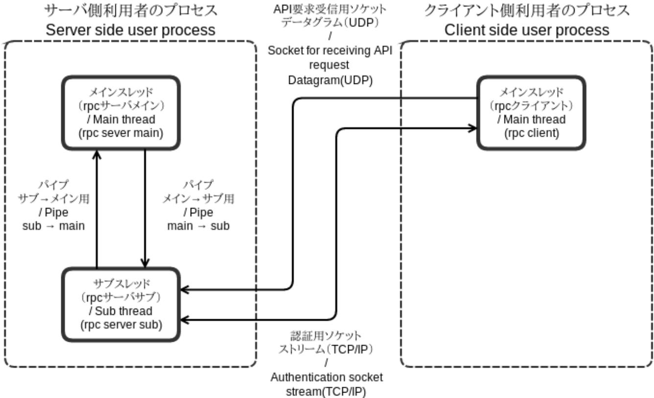
図.全体構成図 [Entire configuration diagram]
